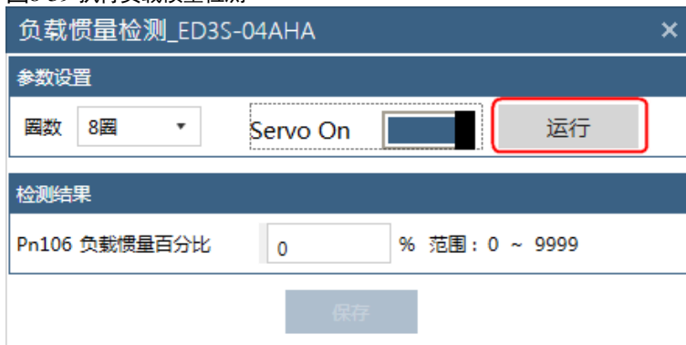
图8-39 执行负载惯量检测
