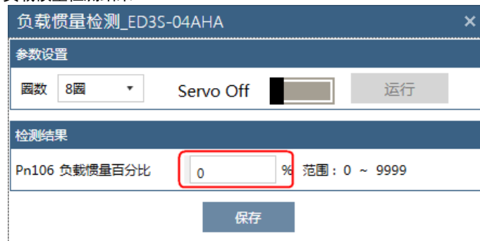
图 11-41 负载惯量检测结果
