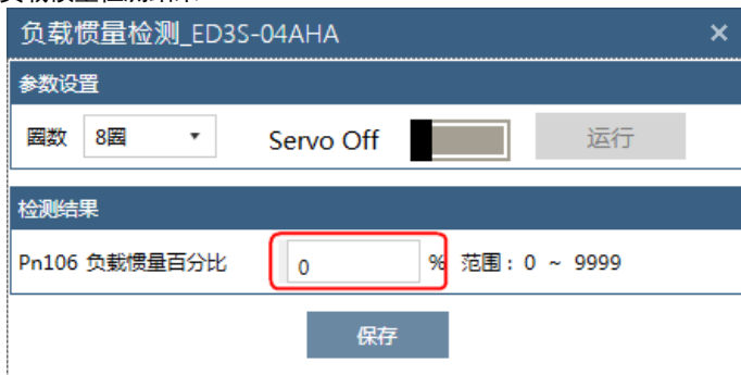
图 11-41 负载惯量检测结果
