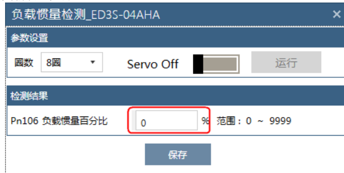
图 11-41 负载惯量检测结果
