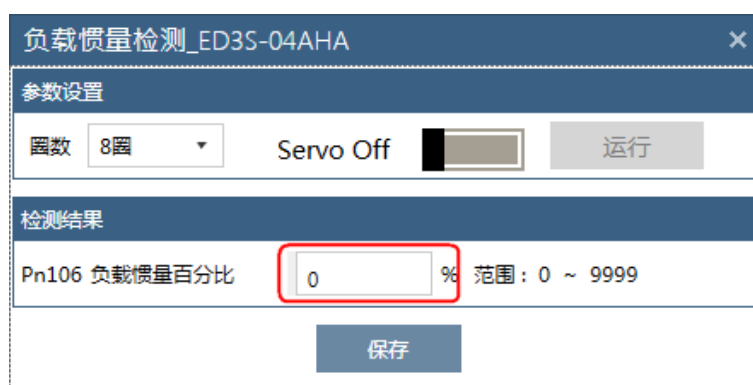
图 11-40 负载惯量检测结果
