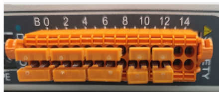
图 4-34 SAFETY IO 短接片插入示意图
